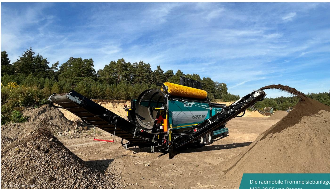
Die radmobile Trommelsiebanlage MPB 20.55 von Pronar
