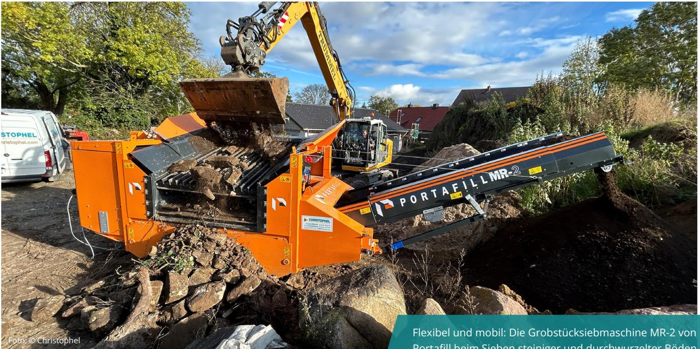
Flexibel und mobil: Die Grobstücksiebmaschine MR-2 von Portafill beim Sieben steiniger und durchwurzelter Böden
