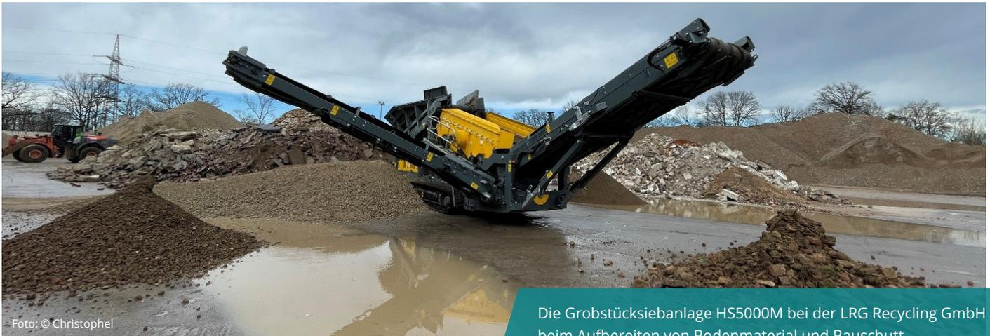
Die Grobstücksiebzanlage HS5000M bei der LRG Recycling GmbH beim Aufbereiten von Bodenmaterial und Bauschutt
