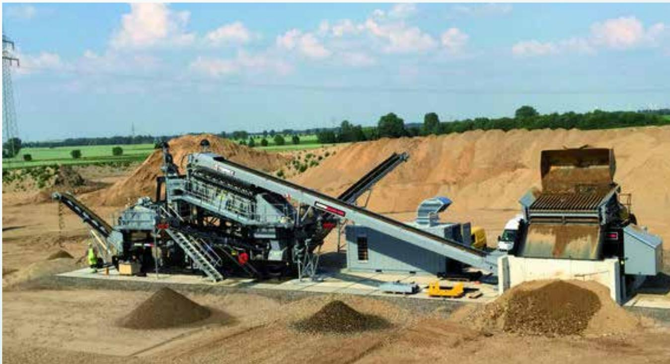
Betonzuschläge und Estrichsand mit modularer Waschanlage flexibel hergestellt. Die Firma SAS – Steding entscheidet sich für eine TWS Waschanlage und bereitet in 2 Monaten 50.000 t Kiessand auf.
