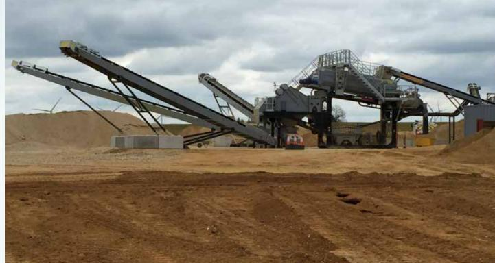
weltweit-führende Hersteller von Baustoffen und Aggresand 206 in der Kombination mit dem AggreScrub Baulösungen. Lafarge Tarmac hat durch innovative 150 bei der Verarbeitung von über 350 t/h Kiessand in drei Lösungen und Produkte den Zugang zu den größten qualifizierte Körnungen und 2 Sandfraktionen zu sehen. Bauprojekten in Großbritannien. Die flächendeckende
