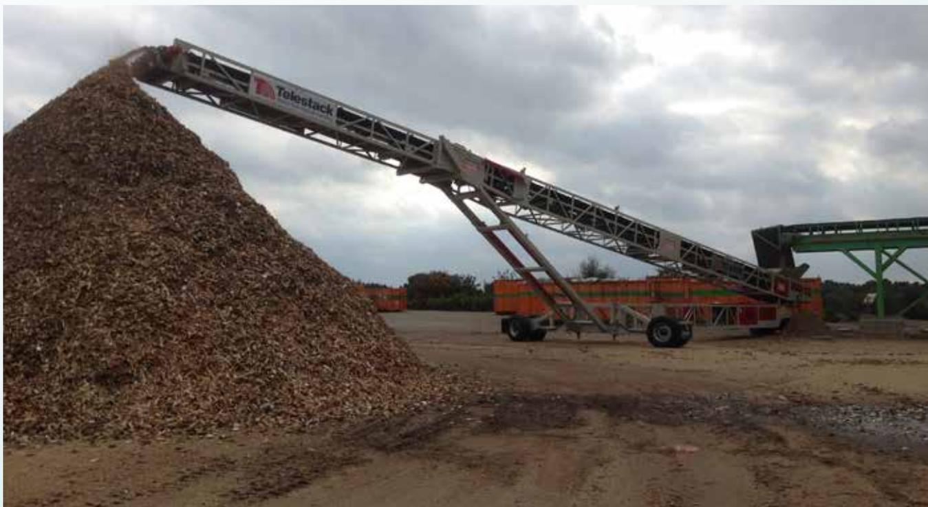
Im Werk Nützen der Fa. Brockmann Recycling GmbH wird das Altholz in der dortigen stationären Aufbereitungsanlage in mehreren Schritten zerkleinert, mit aufwendiger Trenntechnik von Metallen befreit und so zu hochwertigem Brennstoff aufbereitet, welcher zum größten Teil zu einem Heizwerk in Hamburg geliefert wird.
